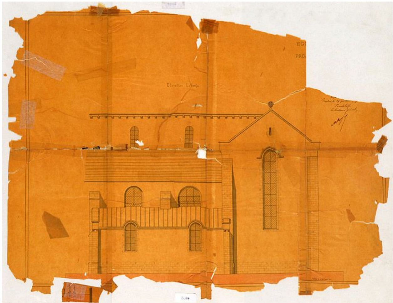
Eglise Notre-Dame : projet de construction des sacristies. Elévation latérale. Calque, encre noire et rouge, 1864-1868. (AM Melun. 1 Fi 2097)
