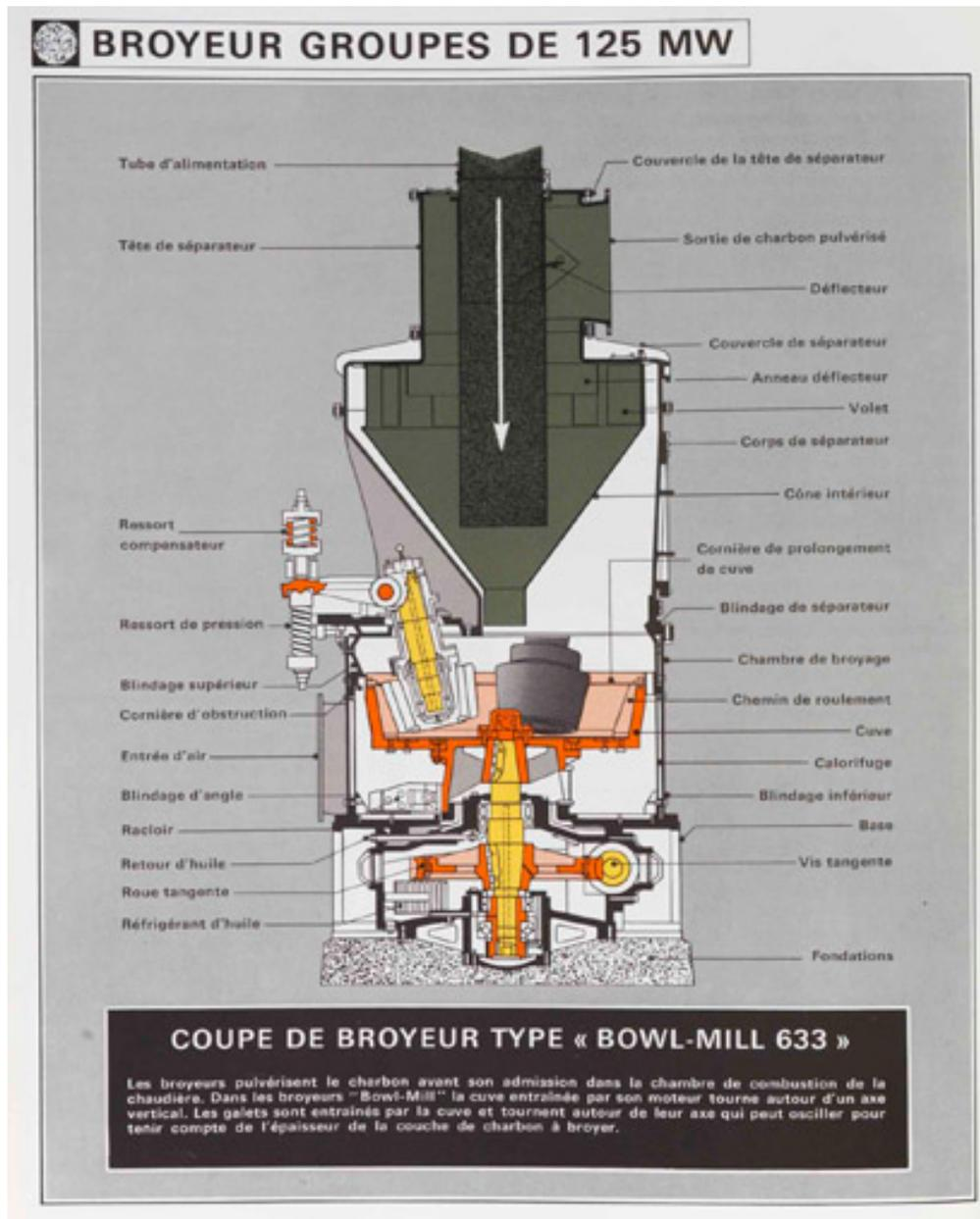
Shema du broyeur groupes de 125 MW, type "Bowl-Mill 633".
