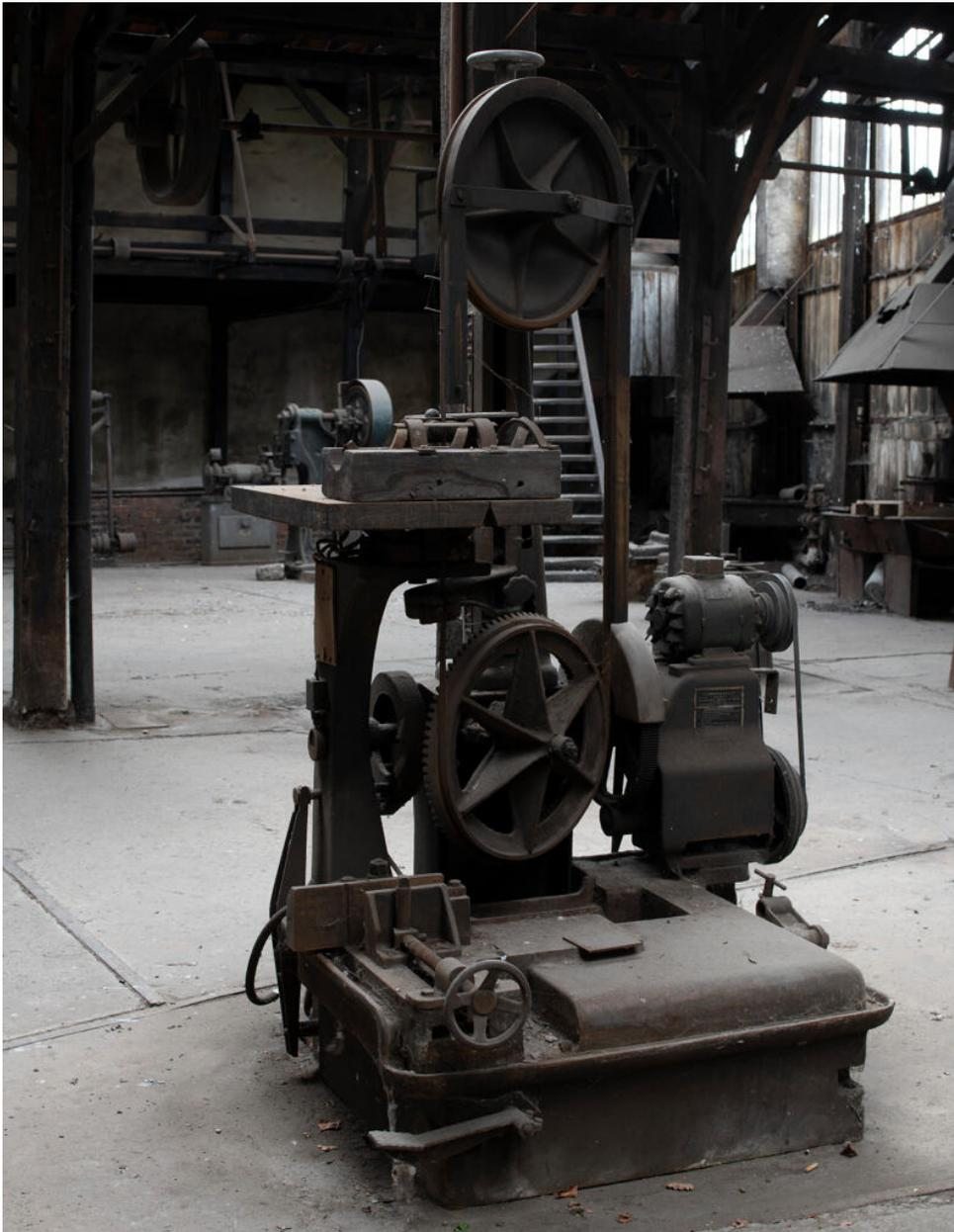
Intérieur de l'atelier des forges. Scie à ruban "Arnoux-Mauny-US1". Plaque signalétique sur le bloc-moteur : « "L'Universelle" / Brevetée S.G.D.G. – Scie N° 1 / De la société M. Arnoux & R. Mauny / Constructeurs / 55, Bd Romain-Rolland – Montrouge – (Seine). ».
