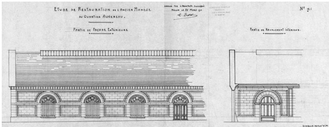
Etude pour la transformation du manège de cavalerie en salle des fêtes : élévation latérale (extérieure et intérieure). Projet de l'architecte melunais Georges Protat (mars 1911), non réalisé. (AM Melun. 1 Fi 1021)
