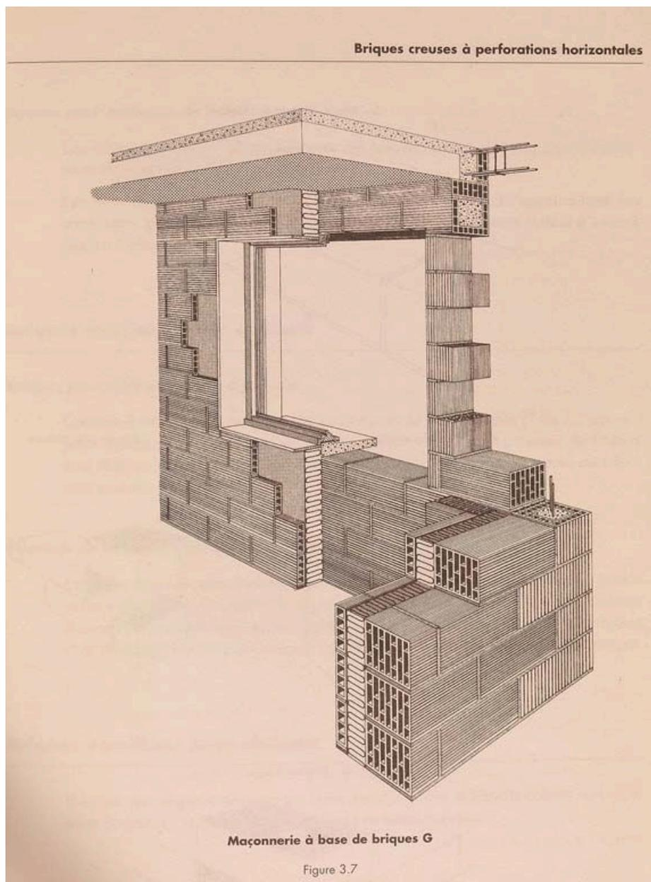
Maçonnerie de brique creuse en double épaisseur avec isolant intermédiaire. Tiré de : Centre technique des tuiles et briques, *Tuiles et briques de terre cuite* / Paris : Le Moniteur, 1998, collection Memento technique.
