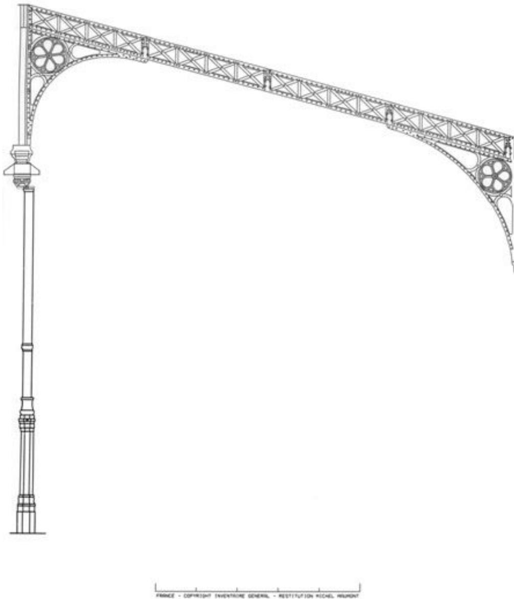
Elévation d'une ferme transversale. Restitution photogrammétrique, 1983.
