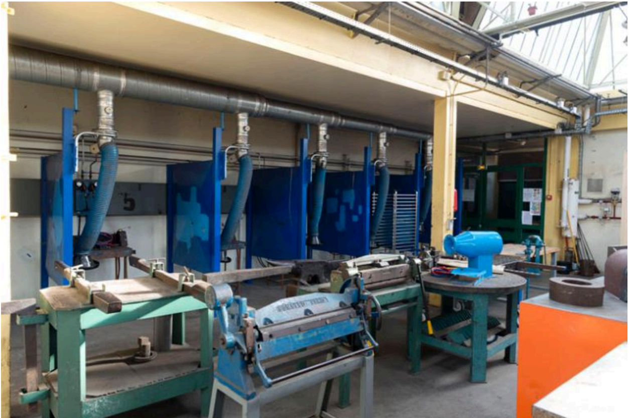
Lycée Rostand : l'atelier de la section Réalisations industrielles en Chaudronnerie et Soudures (RICS). Le système d'aspiration.
