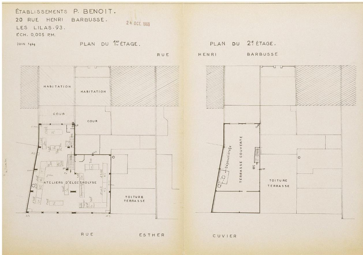
Plans du 1er et du 2e étages, indiquant la fonction des ateliers, 1969 (AD93 1322 W 242).
