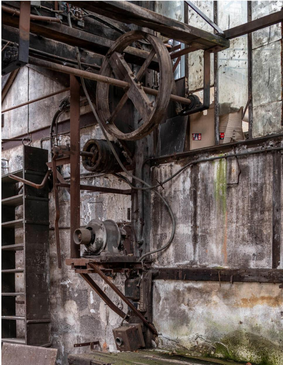
Intérieur de l'atelier des forges. Mécanisme de transmission de la force motrice.
