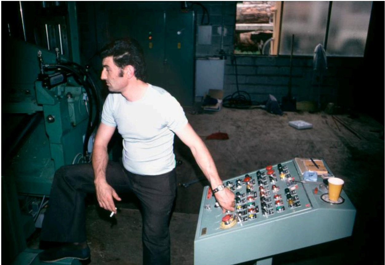
Poste de conduite d'une massicoteuse. (Musée de l'histoire vivante, Montreuil)
