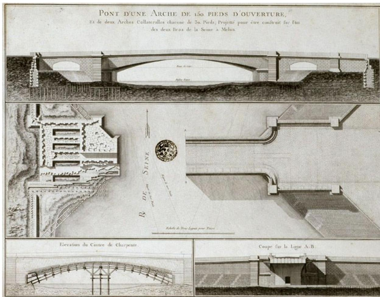
Projet d'une arche de 150 pieds d'ouverture et de deux arches collatérales chacune de 30 pieds, projeté pour être construit sur l'un des deux bras de la Seine à Melun. Cette gravure illustre le projet (non réalisé) de Perronet pour la reconstruction du pont-aux-ruits, sur le petit bras. Gravée par Berthault sous la direction de Lesage, elle fait partie des "Oeuvres complètes" de Perronet. Gravure, 18e siècle. (AN, Cartes et plans. F14 10206 (2), pièce 14)
