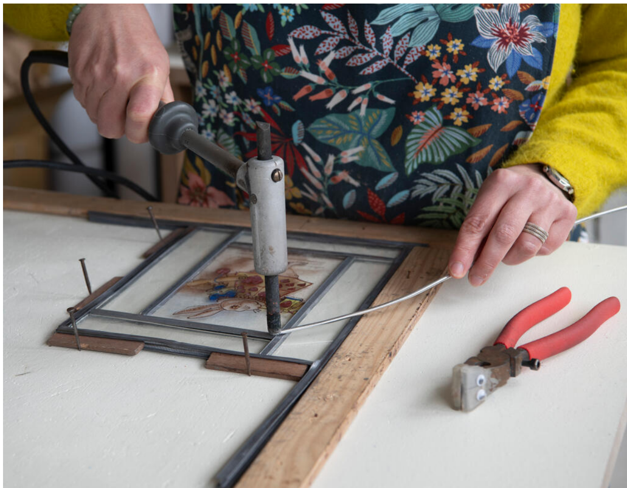
Atelier au Vitrail de Saint-Maur-des-Fossés. Soudure à l'étain, avec un fer à souder.
