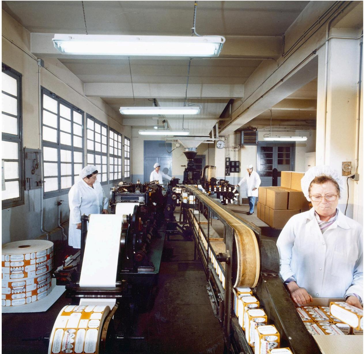
La chaîne de conditionnement du 2e étage du bâtiment principal en activité. A gauche, la machine fabriquant des boîtes pour le vrac (à partir de papier cartonné imprimé et de papier fin formant le sac intérieur). Les boîtes étaient ensuite remplies de tisane à l'aide de la machine au fond (sous le grand entonnoir) et revenaient sur un tapis roulant (le temps que la colle sèche) pour être stockées dans des cartons d'expédition.
