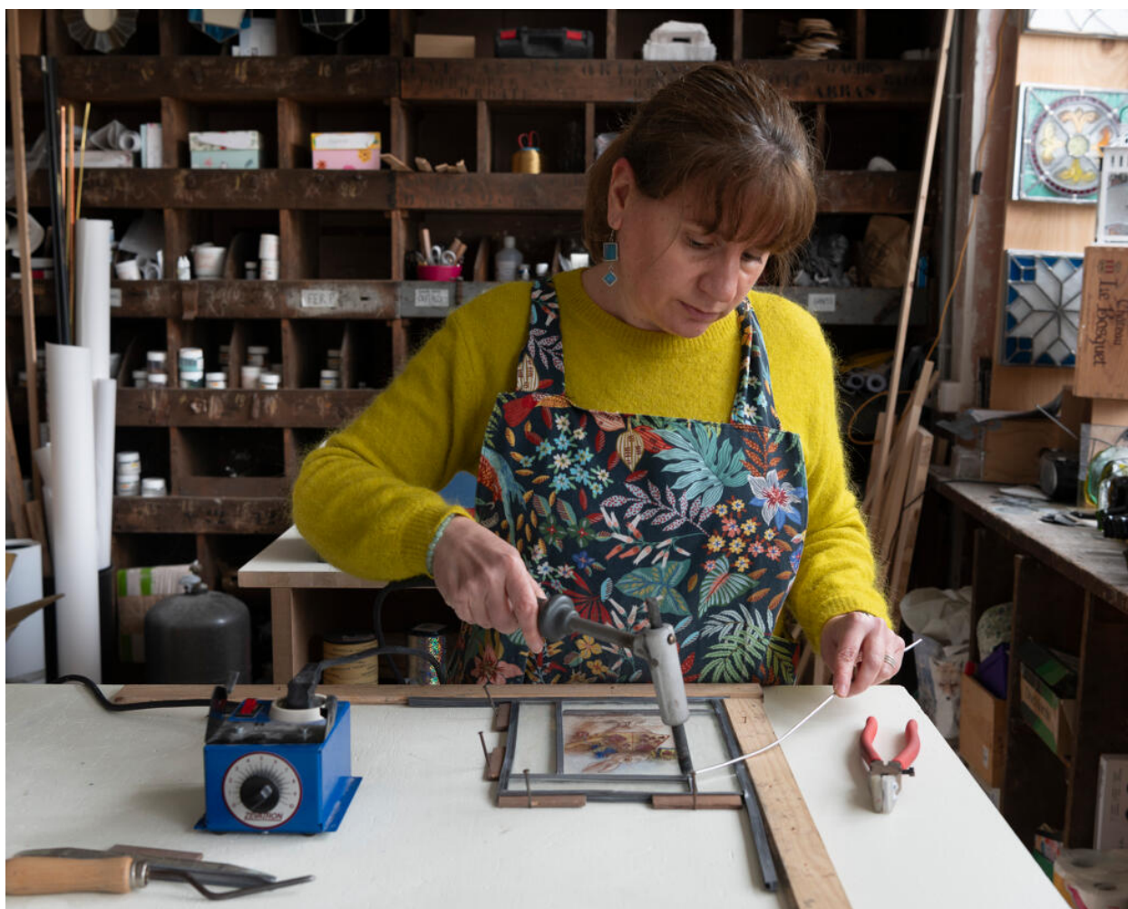
Atelier au Vitrail de Saint-Maur-des-Fossés. Soudure à l'étain, avec un fer à souder.
