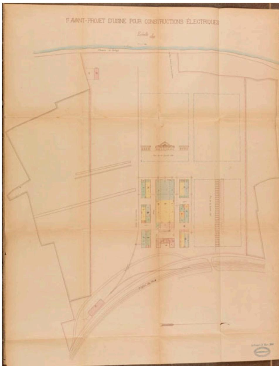
1er avant-projet d'usine pour constructions électriques. Plan Echelle 1/1000e. Quatre modules étaient prévus. un seul sera réalisé. 31 mars 1900
