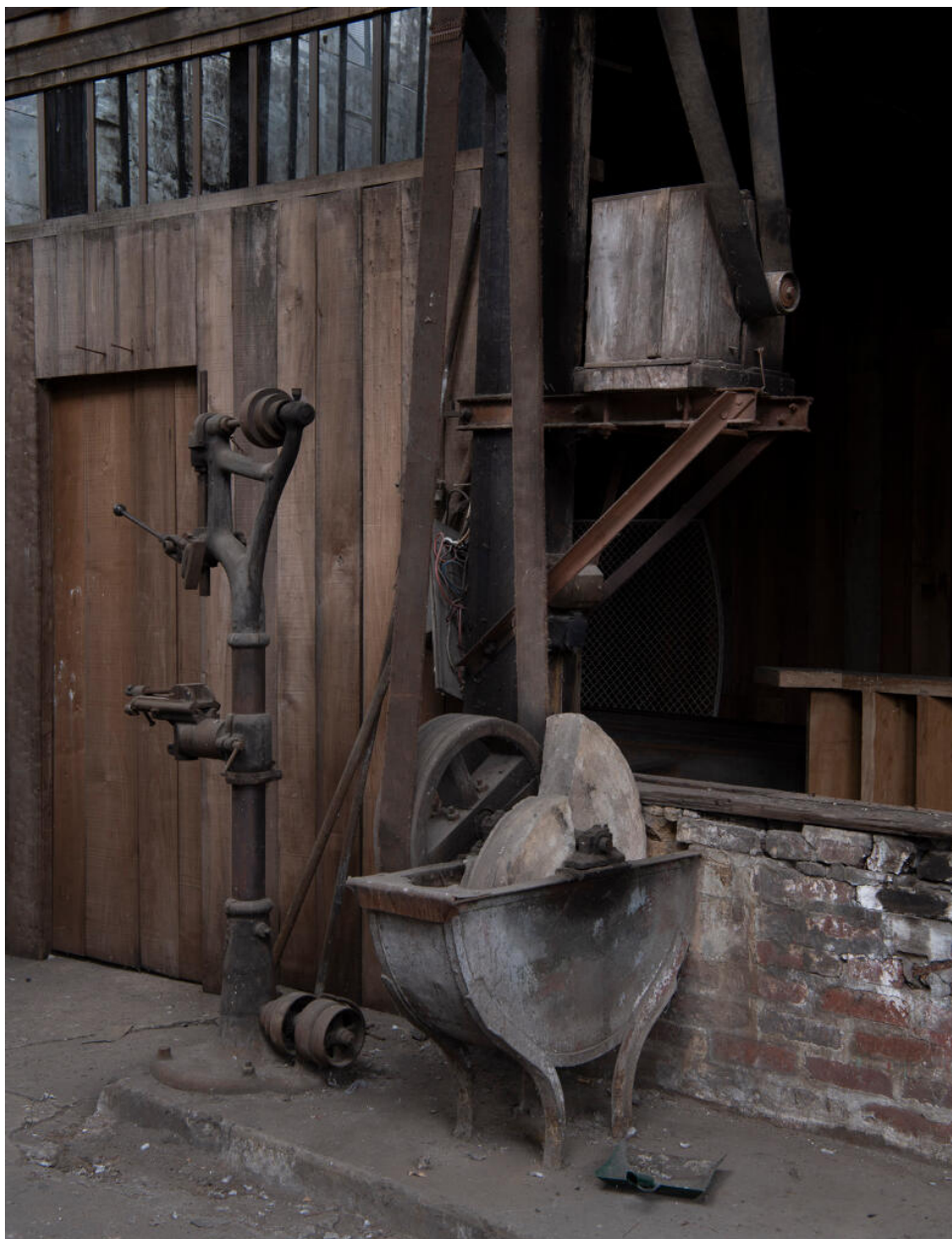
Intérieur de l'atelier des forges. À gauche, perceuse à colonnes.
