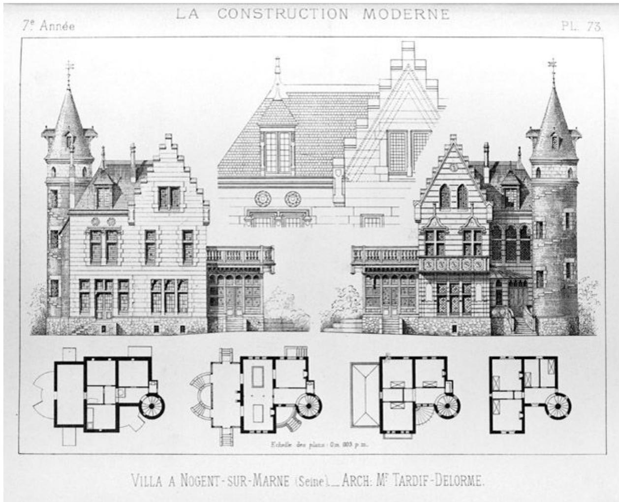
Plans des sous-sols, rez-de-chaussée, premier étage et étage de comble (de gauche à droite), élévations antérieure (à droite) et postérieure (à gauche) et détail de l'élévation postérieure. Tiré de : La construction moderne, 1891-1892, t.7. (
