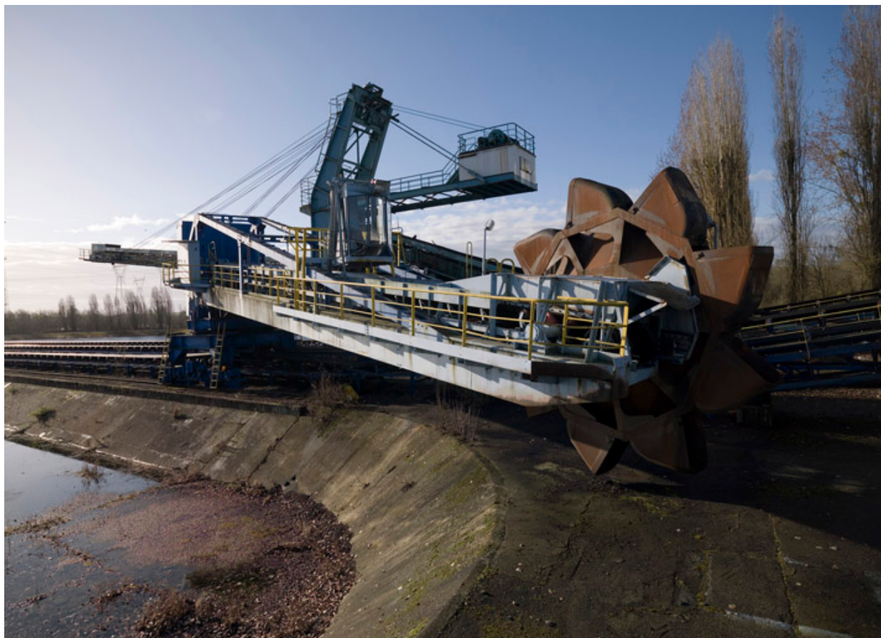
Parc a charbon. Manutention. Roue-pelle.
