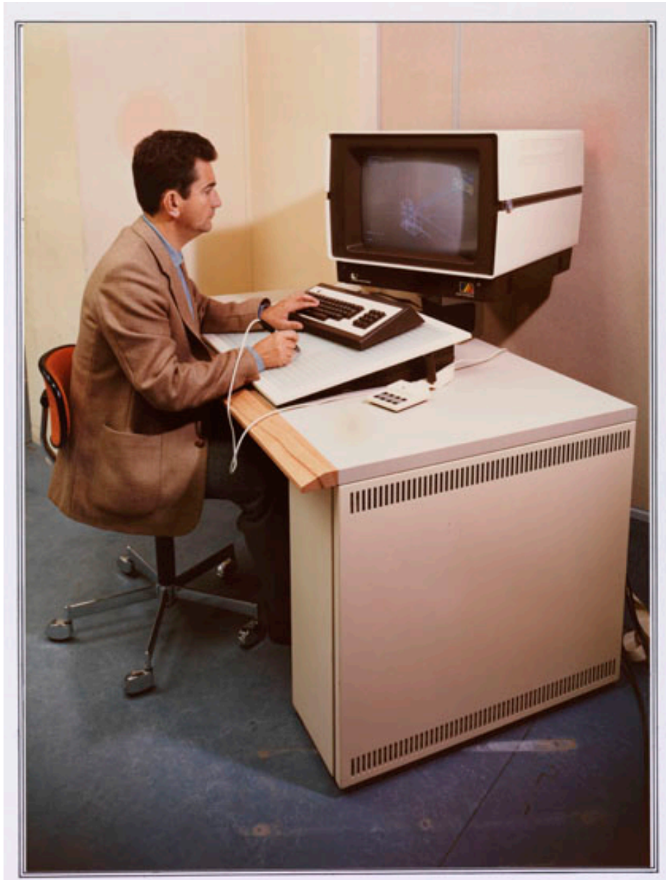
Photo ancienne. Poste de travail pour CAO (conception assistée par ordinateur). Ecran, tablette à digitaliser et boîtier de contrôle d'écran. Photographie J-S, 1984.
