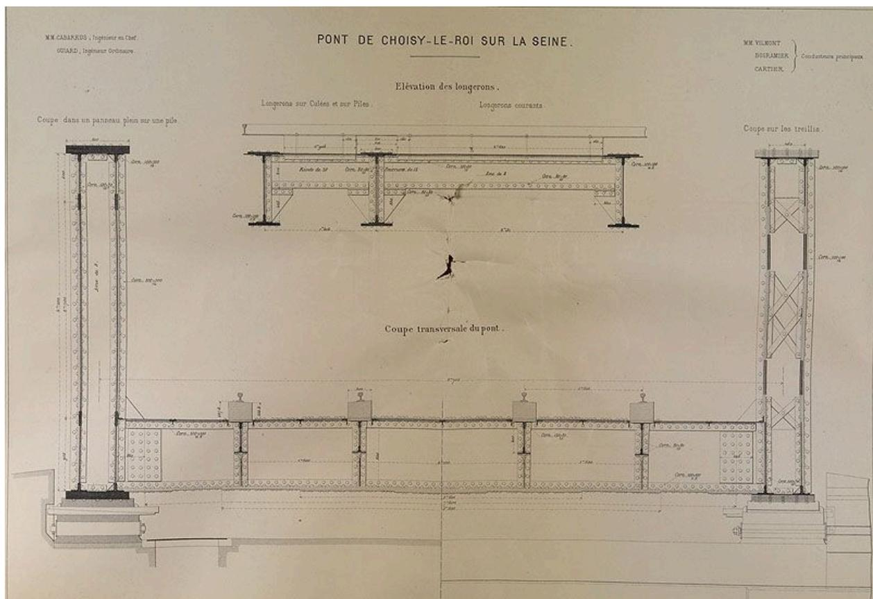
Choisy-le-Roi. Pont ferroviaire de la Grande Ceinture. Coupe transversale du pont et élévation des longerons. (Ecole nationale des ponts et chaussées)
