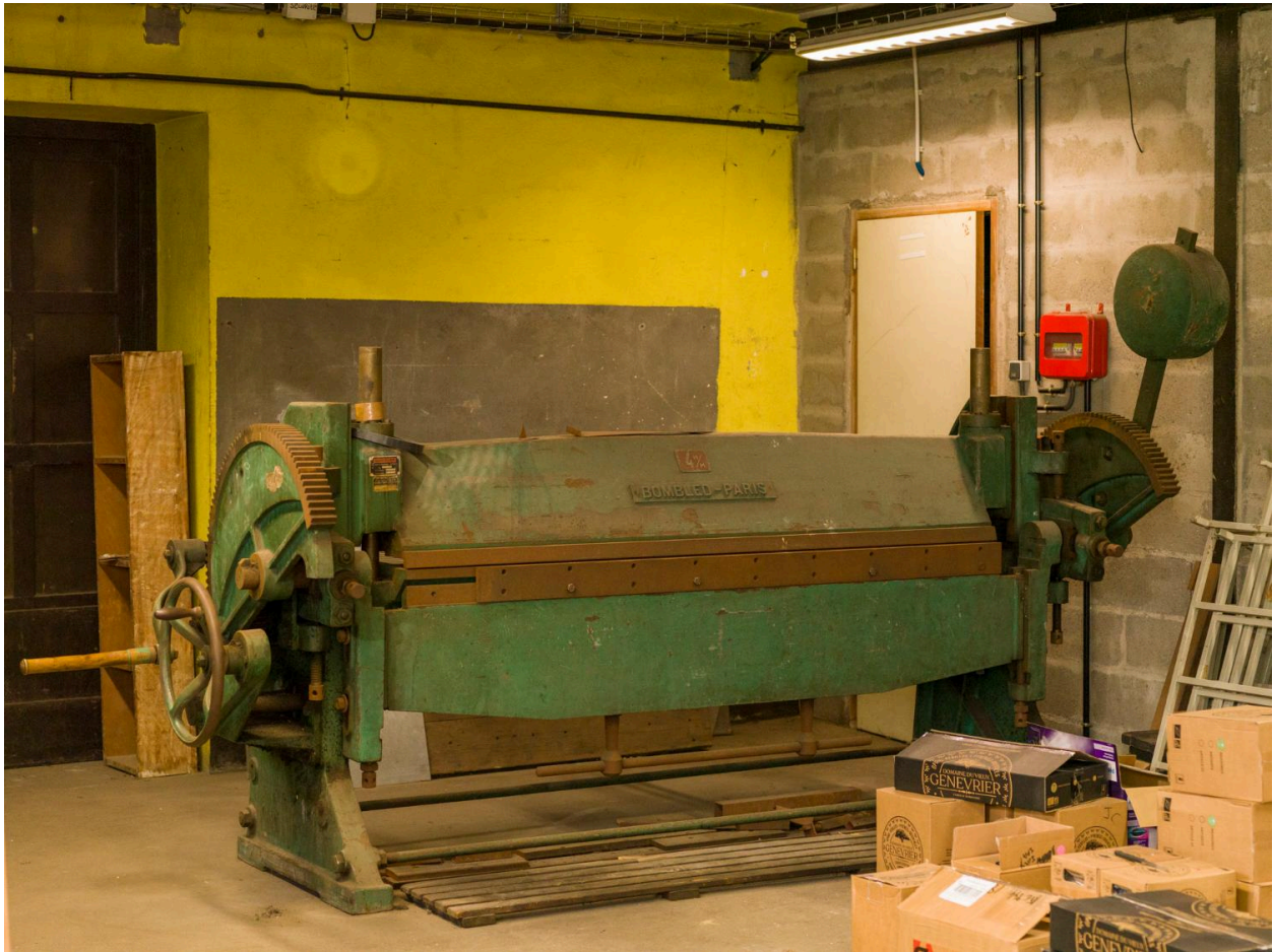
Chaudronnerie métallique. Plieuse manuelle de marque BOMBLED-PARIS, pour plier des tôles jusqu'à 4 millimètres d'épaisseur.
