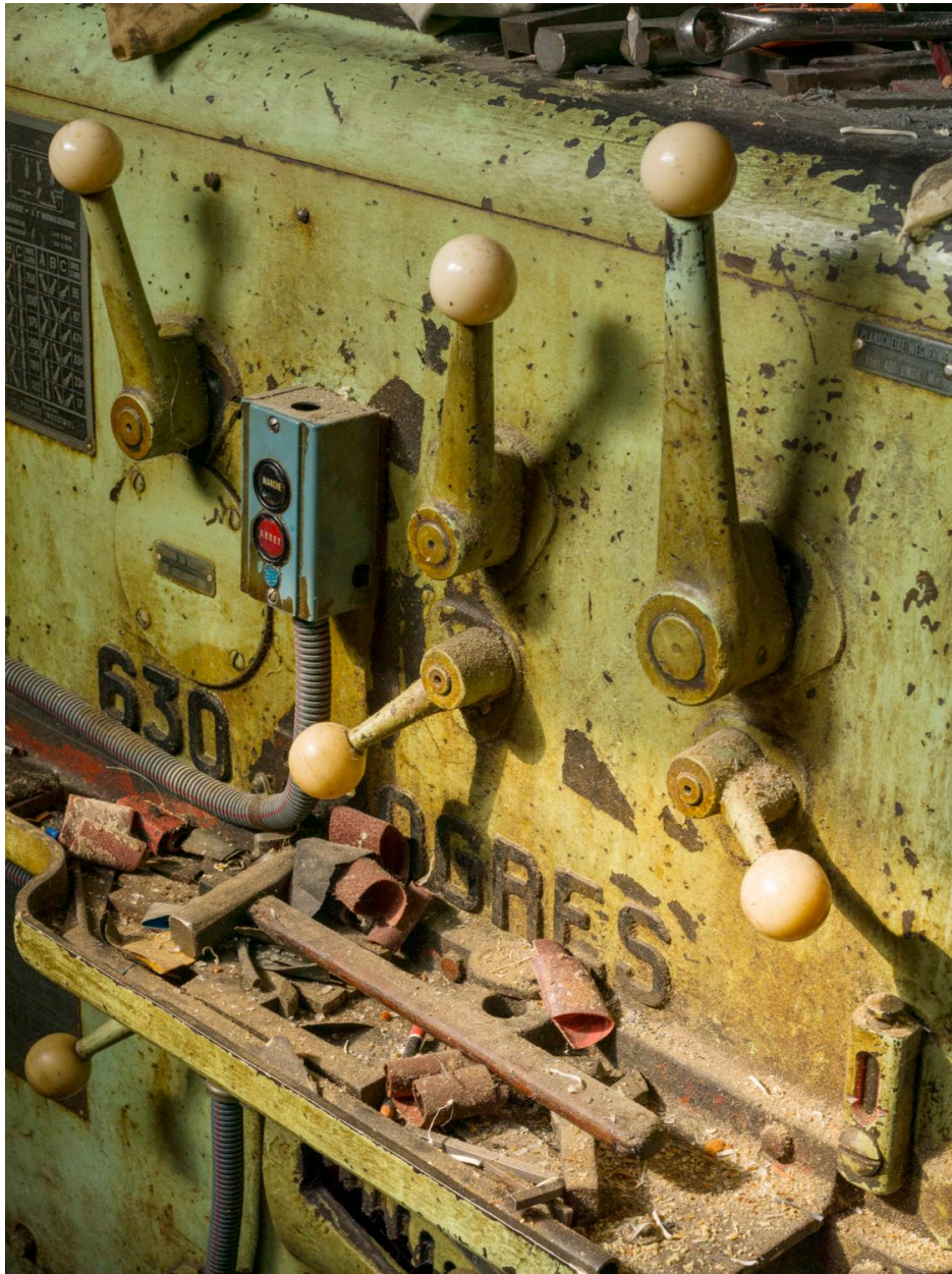
Atelier de mécanique générale (usinage). Tour parallèle Le Progrès Industriel. Leviers de la boîte de vitesse.
