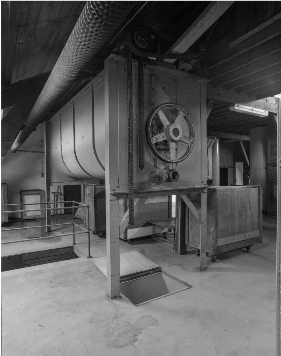
Grand mélangeur en acier, placé au 4e étage du bâtiment principal à côté des silos. Capacité correspondant à la production de 10 à 12 000 boîtes de tisane. Un conduit permettait d'acheminer le mélange de plantes directement au 2e étage dans un entonnoir alimentant la machine de conditionnement. En haut à gauche, radiateur de chauffage à la vapeur permettant de déshumidifier les plantes stockées dans les silos. A droite, wagonnet en bois permettant le transport des mélanges.
