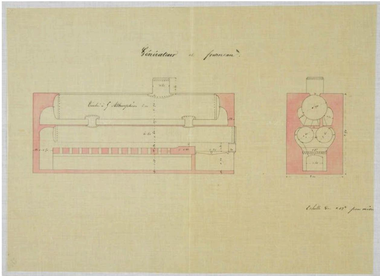
Coupe des chaudières cylindriques, à balancier et à condensation, installée à la station de pompage en 1858. (AD Seine-et-Marne, 5MP181)
