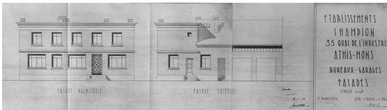
Projet de reconstruction des bâtiments de la société Champion : élévations du bâtiment à usage de logement, bureaux et garages, dressées par les architectes Thivier et Poggi, 25 mars 1949. Ce bâtiment destiné au logement du directeur a seul fait l'objet d'une demande de permis de construire, la réalisation des autres constructions prévues au programme initial de reconstruction (services sociaux et garage, bureaux) ayant été abandonnée.
