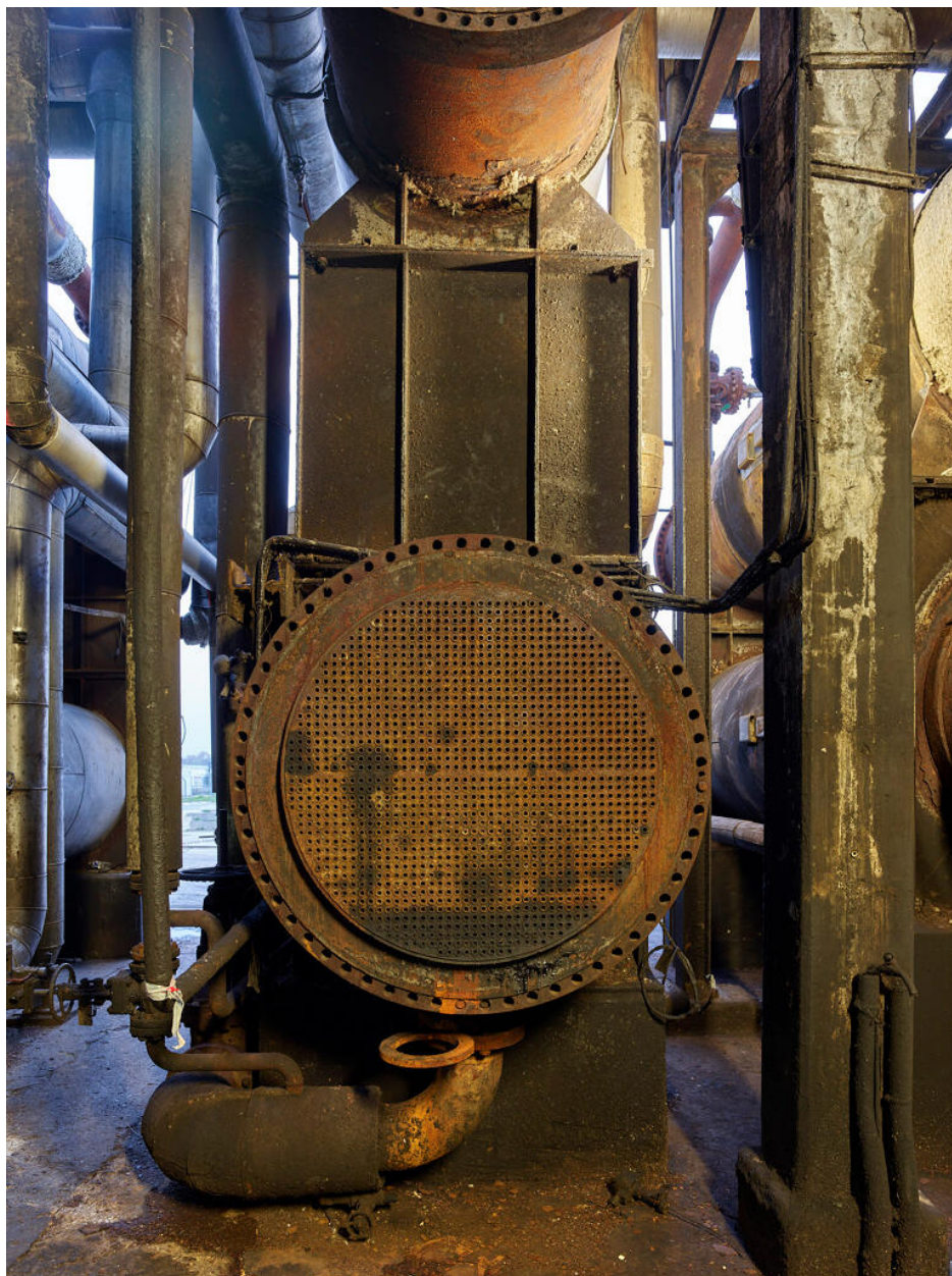
Unités Ouest - Zone de distillation (Unité 612). Echangeur tubulaire avec son faisceau central.
