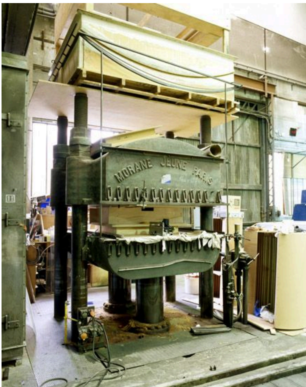
Usine d'ouvrages en matière plastique dite entreprise BFP-Cindar, 48 avenue du Général de Gaulle. Atelier de l'entreprise : détail d'une presse à vérens.
