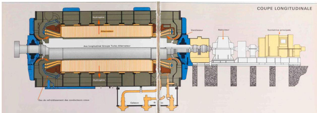
Coupe longitudinale de l'alternateur de 250 MW
