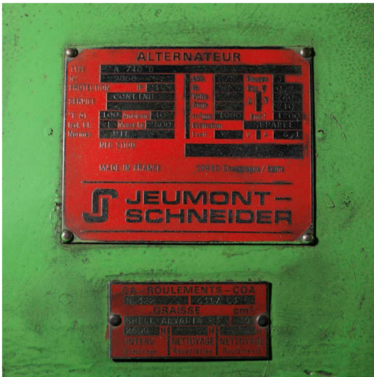
Plateforme d'essais. Entreprise Jeumont-Electric. Plaque d'identification d'un alternateur Jeumont-Schneider.
