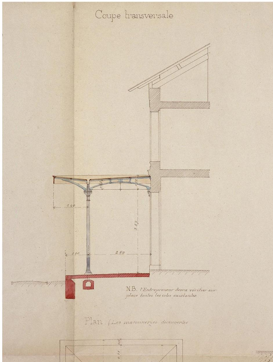
Installation d'une marquise métallique sur la façade côté voies de la première gare : détail de la marquise, coupe transversale. Plan aquarellé, 24 octobre 1893.
