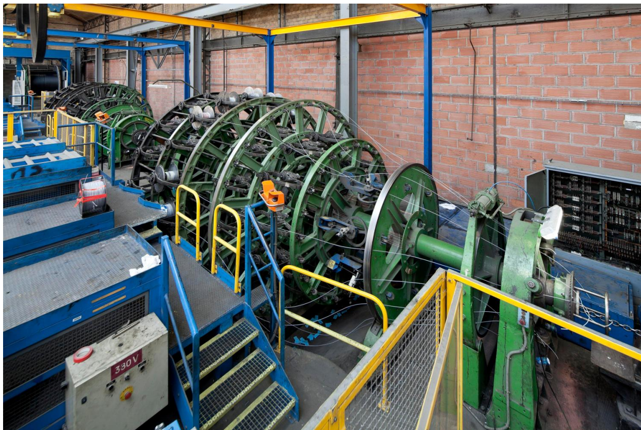
Atelier de fabrication CT1, tréfileuse, vue d'ensemble. (réf. Département de Seine-et-Marne : IVD77_2013_77_00322_NUCA)
