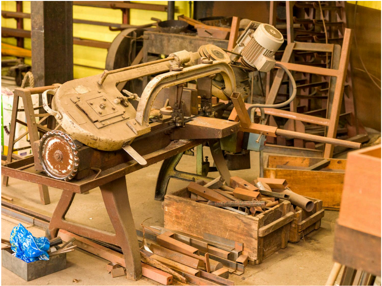
Chaudronnerie métallique. Scie à ruban pour le découpage de la matière métallique. De provenance américaine.
