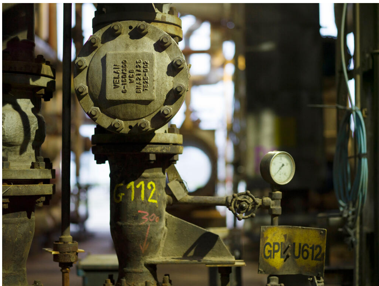
Unités Ouest - Zone de distillation (Unité 612). Pompe GM112, véhiculant des GPL.
