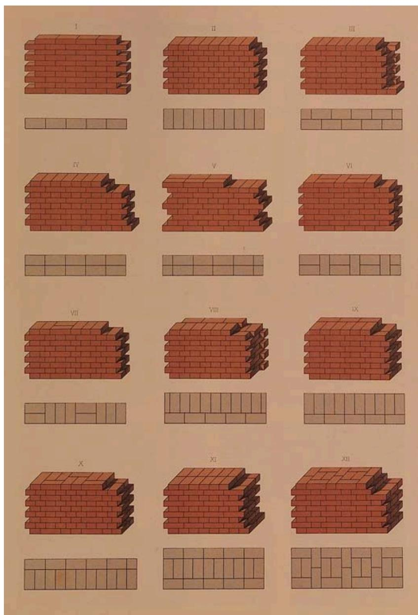
Catalogue de types d'appareillages pour murs de briques : exemples publiés par P. Chabat dans "La brique et la terre cuite...", planche 1.
