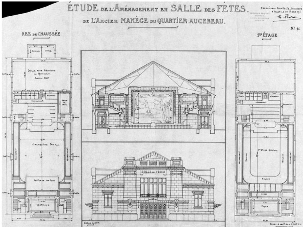
Etude pour la transformation du manège de cavalerie en salle des fêtes : plans, façade et coupe. Projet de l'architecte melunais Georges Protat (mars 1911), non réalisé. (AM Melun. 1 Fi 1022)
