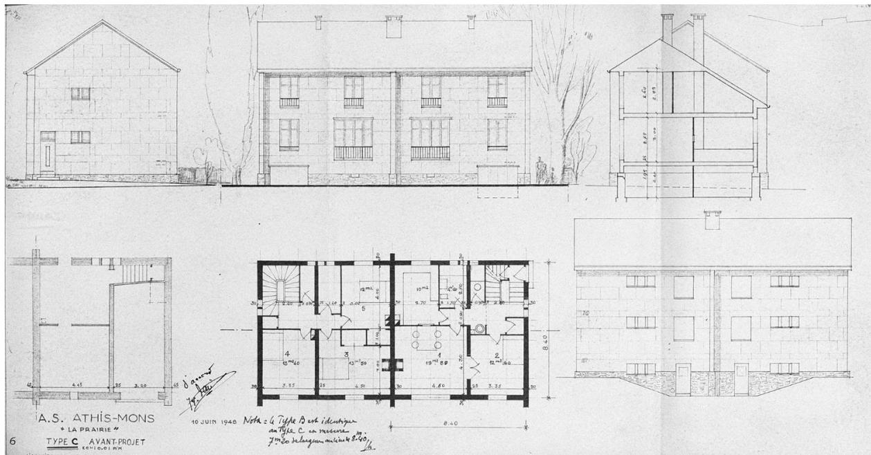
Avant-projet du type C ; 10 juin 1948. En note : 'Le type B est identique au type C et mesure 7, 20 m au lieu de 8, 40 m'.
