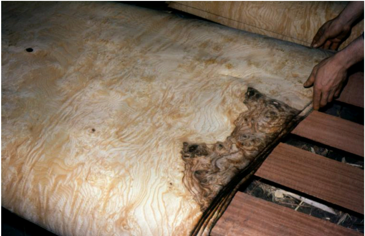
Feuille de loupe de frêne sortant de la dérouleuse (3). (Musée de l'histoire vivante, Montreuil. IB 14)
