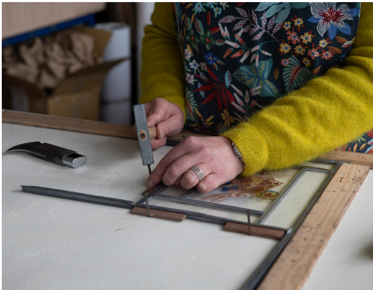
Atelier au Vitrail de Saint-Maur-des-Fossés. Sertissage au plomb, avec marteau et clou. À gauche, le couteau à plomb.
