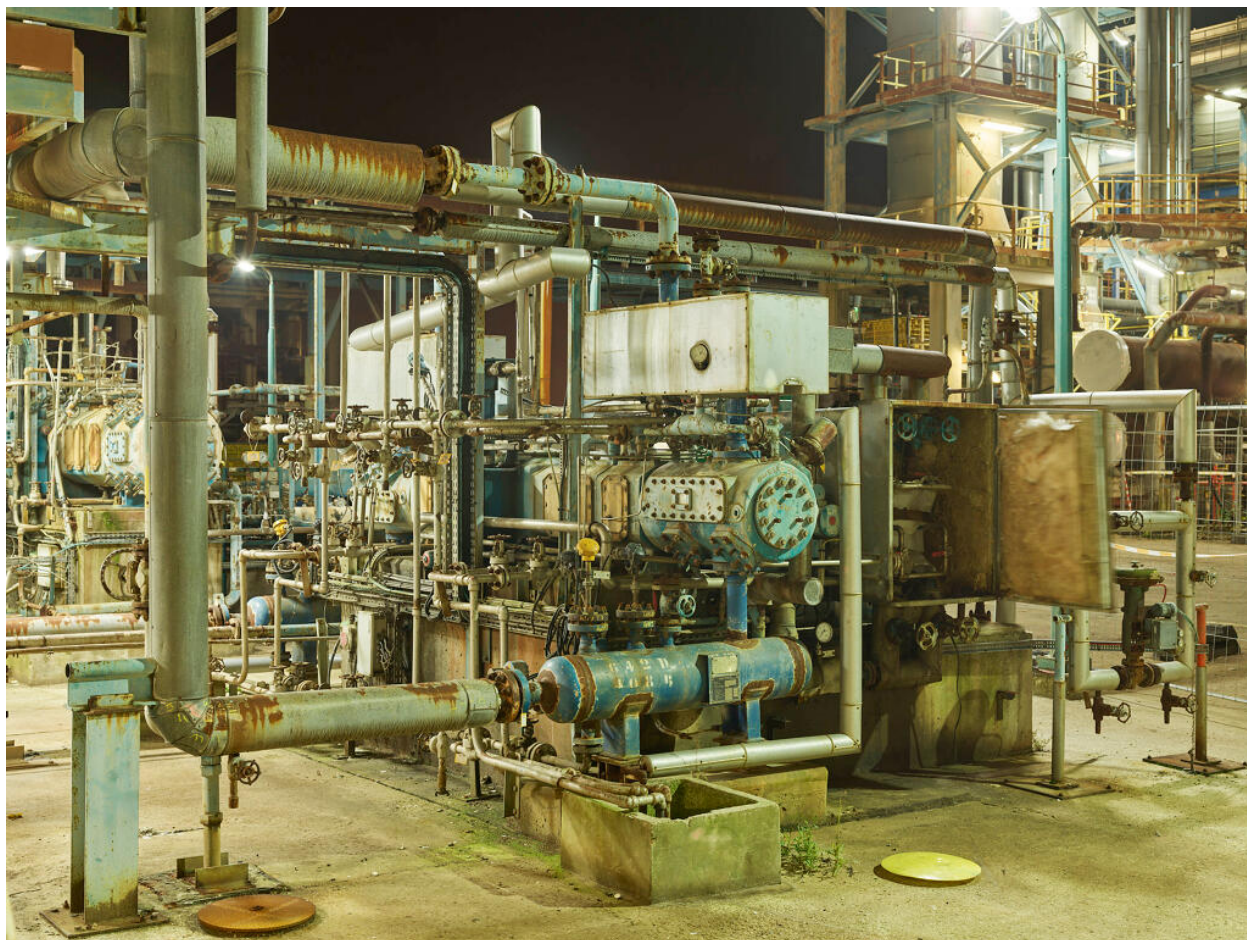
Unités Ouest - Reformeur catalytique (Unité 642). Compresseur alternatif d'hydrogène de la partie HDT2 de l'Unité 642.
