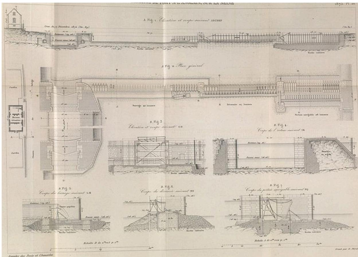
Alfortville, Vitry-sur-Seine. Barrage éclusé de Port-à-l'Anglais. Elevations et plans. Tiré de : Nouvelle passe navigable établie en 1870 sur le barrage de Port-à-l'Anglais. Hausses mobiles supportant une retenue de 4 m / M. Boule. In Annales des Ponts et Chaussées, 2e semestre 1873, n° 42.
