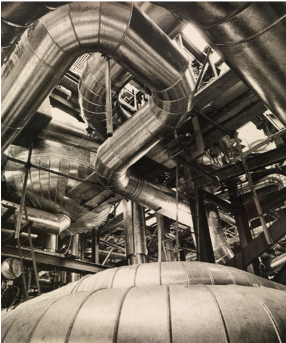
5 - Générateur de vapeur chauffée par sodium reproduisant les conditions réelles d'exploitation d'une centrale nucléaire à réacteur rapide. (Photothèque E D F).
