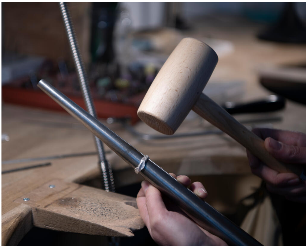
Atelier de bijouterie Siana Swieca Bijoux. Mise à taille d'une bague en argent sur le triboulet, à l'aide d'un maillet.
