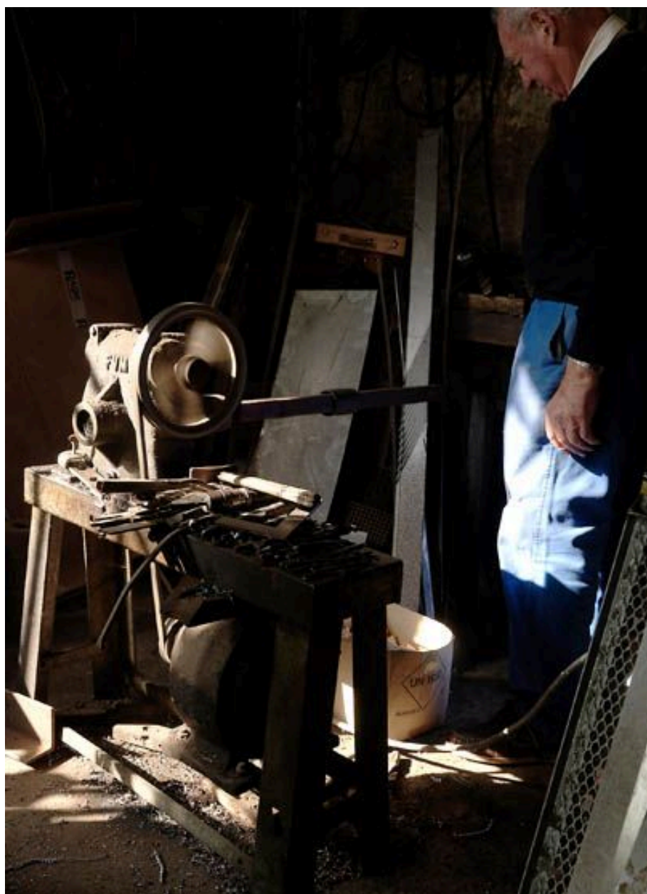
Machine a torsader a froid les sections de fer, mise au point par Mr. Durand.
