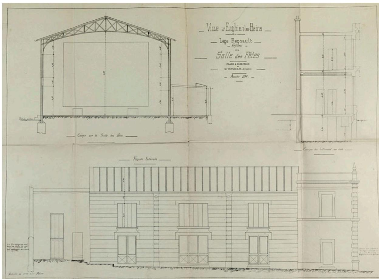
Coupe transversale sur la ferme métallique de la salle, élévation latérale, 1895. (AM Enghien-les-Bains, M10)
