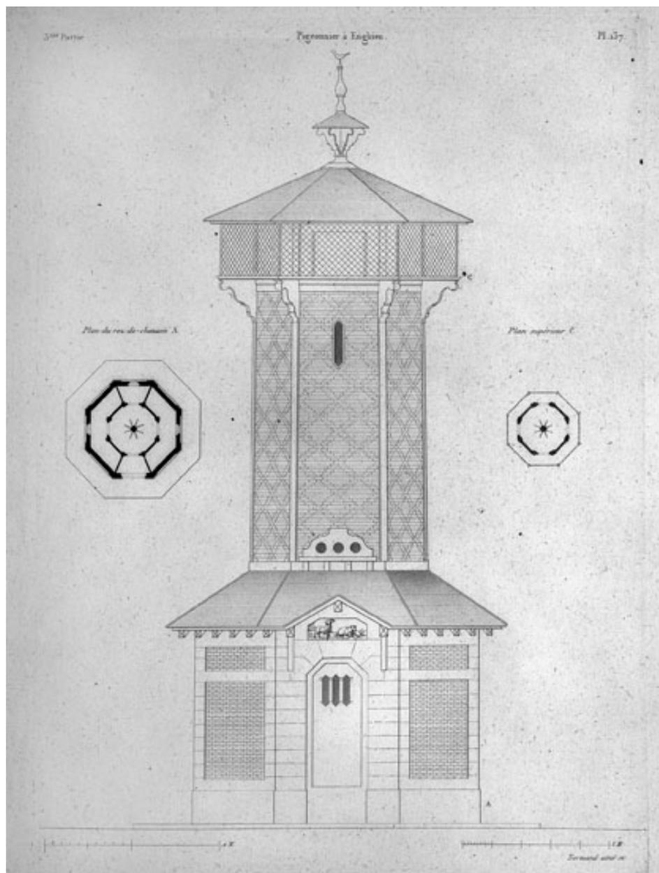
Plans et élévation du colombier. Sur le plan du rez-de-chaussée est figuré l'arbre central pivotant qui permet de visiter les boulines. Gravure. (BHVP, in fol. 10 84)
