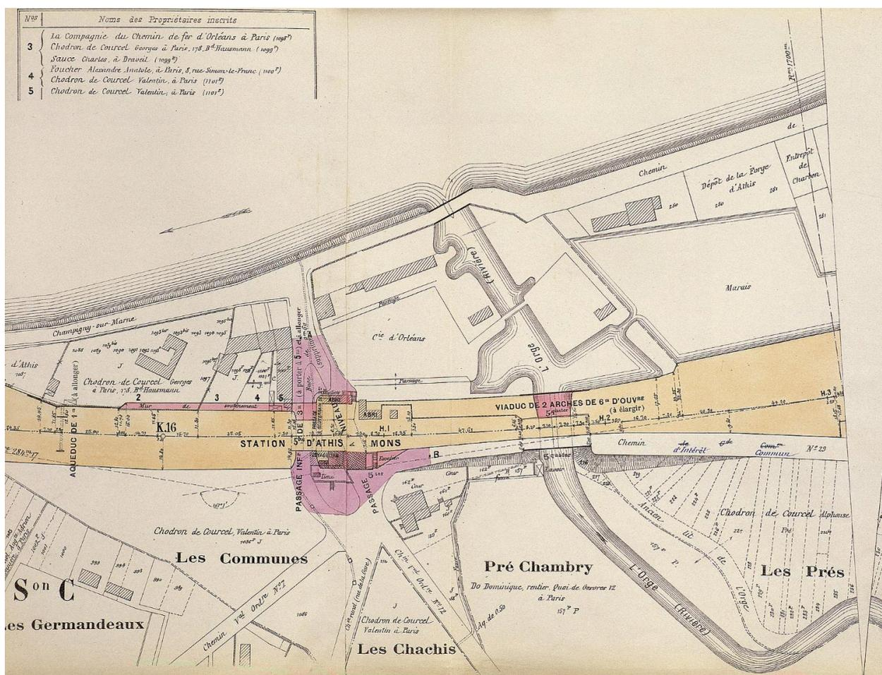
Etat de la station d'Athis-Mons en 1902 avant le doublement des voies du P.O. (première gare) ; encadrant le bâtiment des voyageurs, le passage à niveau et le passage souterrain piétonnier. En rose, les terrains à acquérir en prévision des travaux de doublement des voies.
