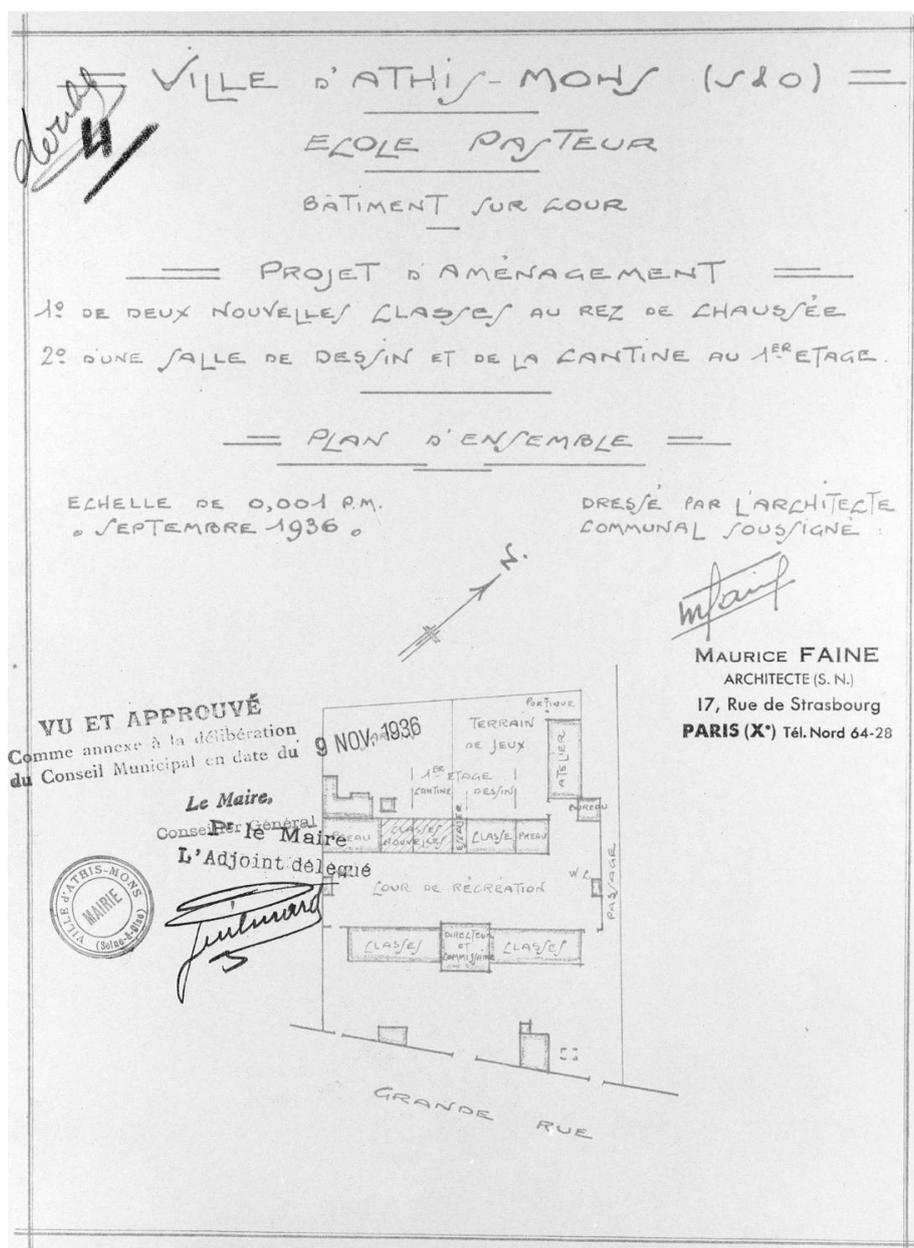
Projet d'aménagement, dans le bâtiment situé en fond de cour, de 2 nouvelles classes au rez-de-chaussée et d'une salle de dessin et d'une cantine au 1er étage, en remplacement de 3 logements désaffectés ; Maurice Faïne, architecte à Paris, septembre 1936.
