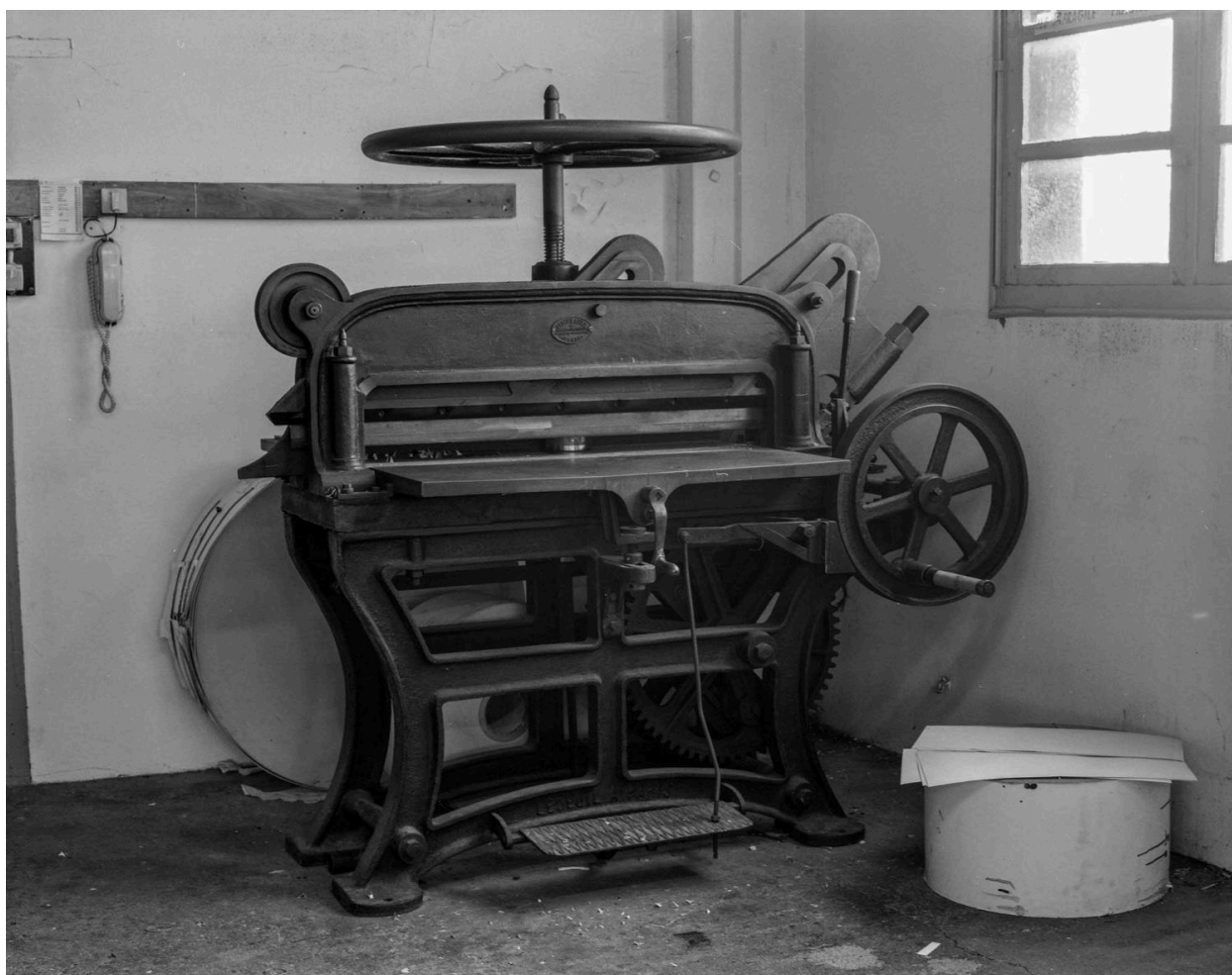
3e étage du bâtiment principal. Atelier d'imprimerie, détail d'un massicot.
