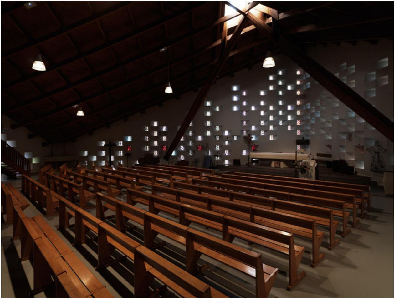
Vue intérieure du chœur. Les parois sont percées d'ouvertures ébrasées laissant perler l'éclairage naturel, dont l'intensité varie avec le jour. La charpente lamellée-collée est axée sur la diagonale.
