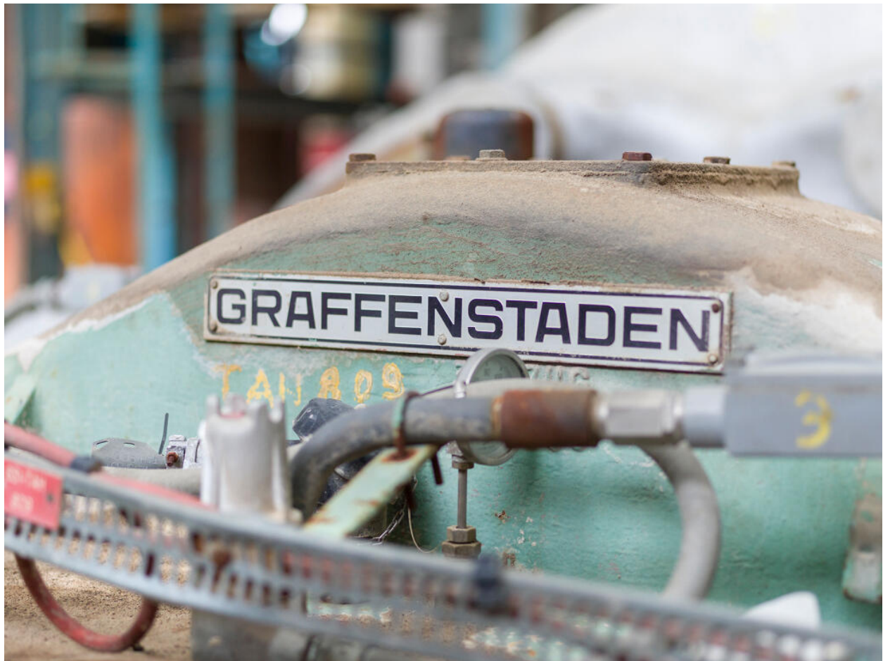
Unités Est - Zone FCC (Unité 651). Compresseur turbo-alternateur, autrement dit compresseur à récupération d'énergie. Plaque du fabricant Graffenstaden du coupleur.
